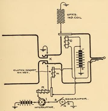
FIG. 288.-WESTERN ELECTRIC AUTOMATIC RINGING CIRCUIT.
