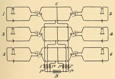
FIG. 230.—STONE COMMON BATTERY ARRANGEMENT.
