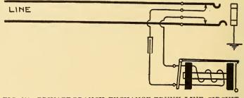
FIG. 304.—PRIVATE-BRANCH EXCHANGE TRUNK LINE CIRCUIT— WESTERN ELECTRIC SYSTEM.
