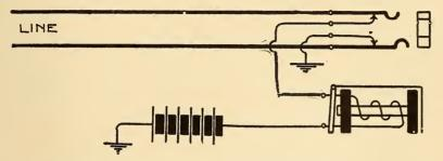
FIG. 303.—PRIVATE-BRANCH EXCHANGE SUBSCRIBERS' LINE CIRCUIT— WESTERN ELECTRIC SYSTEM.
