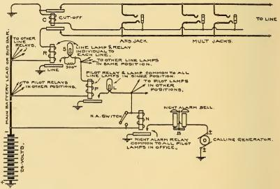
FIG. 267.-WESTERN ELECTRIC LINE AND PILOT CIRCUITS.
