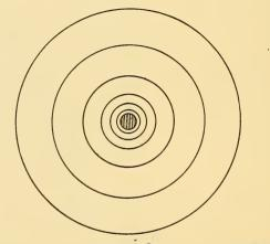
FIG. 140.-MAGNETIC LINES AROUND A CONDUCTOR.
