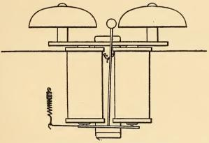
FIG. 104 .- DIAGRAM OF BIASED BELL.
