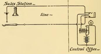
FIG. 239.-LINE CIRCUIT.
