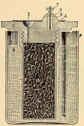
FIG. 67.-SECTIONAL VIEW OF CARBON CYLINDER LECLANCHE CELL.
