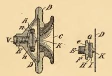
FIG. 17.—PHELPS-EDISON TRANSMITTER.
