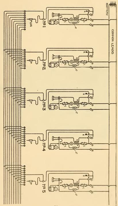
FIG. 523.-COMMON BATTERY HOUSE SYSTEM.
