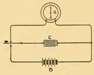
FIG. 638.—CAPACITY TEST.
