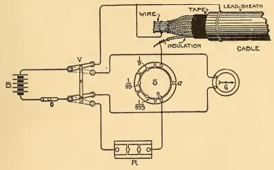
FIG. 637.-CONNECTION FOR INSULATION TEST.
