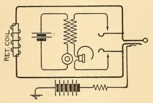
FIG. 471.-WIRE CHIEF'S TELEPHONE CIRCUIT.
