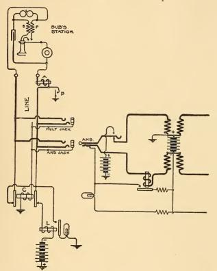
FIG. 346.—CIRCUIT OF STROUD COIN-COLLECTING SYSTEM.
