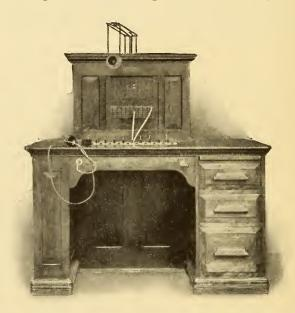
FIG. 316 .- PRIVATE-BRANCH EXCHANGE SWITCH-BOARD.
