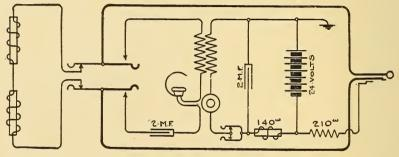
FIG. 460.-CHIEF OPERATOR'S TELEPHONE CIRCUIT.
