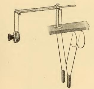
FIG. 194.-OPERATOR'S TRANSMITTER SUSPENSION.
