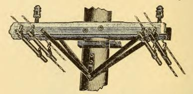
FIG. 593.-CROSS-ARM FOR MESSENGER SUPPORT.
