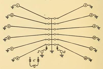
FIG. 154.-GROUNDED-CIRCUIT SWITCH-BOARD.
