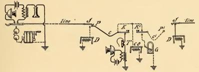
FIG. 160.-CIRCUITS MAGNETO SWITCH-BOARD-OPERATOR ANSWERING.
