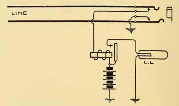
FIG. 305 .- PRIVATE-BRANCH EXCHANGE SUBSCRIBERS' LINE CIRCUIT.
