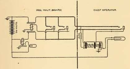
FIG. 463.-CHIEF OPERATOR'S LINE TO MULTIPLE BOARD.
