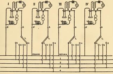
FIG. 522.-CIRCUITS OF ORDINARY HOUSE SYSTEM.
