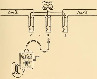
FIG. 200.—CIRCUITS OF TOLL CUT-IN STATION.
