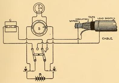
FIG. 640.-CIRCUITS FOR CAPACITY TEST.
