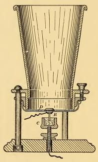
FIG. 13.-BELL'S CENTENNIAL LIQUID TRANSMITTER.
