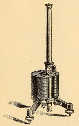
FIG. 630.-D'ARSONVAL GALVANOMETER.
