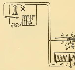
FIG. 179.-BELL SELF-RESTORING DROP.
