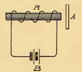
FIG. 1.-STURGEON ELECTROMAGNET.
