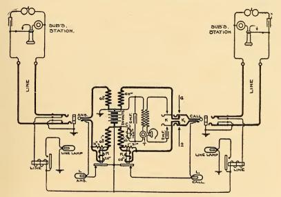
FIG. 248 .- TYPICAL CIRCUITS FOR SMALL COMMON-BATTERY BOARD.
