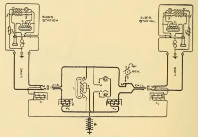
FIG. 251.-CIRCUITS OF DEAN COMMON-BATTERY SWITCH-BOARD.
