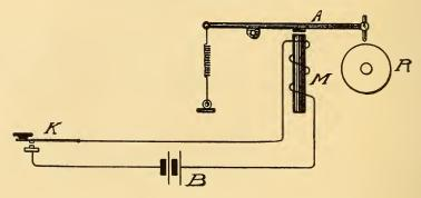
FIG. 4.-MORSE ELECTROMAGNETIC TELEGRAPH.
