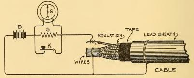
FIG. 636.—INSULATION RESISTANCE OF CABLE.
