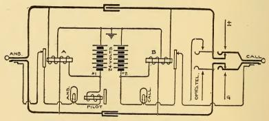
FIG. 315.-CORD CIRCUIT FOR PRIVATE-BRANCH EXCHANGE SYSTEM.
