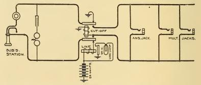
FIG. 268.-KELLOGG MULTIPLE SWITCH-BOARD LINE CIRCUIT.
