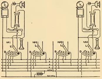
FIG. 525.-CIRCUITS OF HOLTZER-CABOT SYSTEM.
