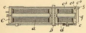
FIG. 178.-BELL SELF-RESTORING DROP.
