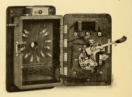
FIG. 524.-NESS AUTOMATIC SWITCH FOR HOUSE SYSTEMS.
