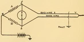
FIG 643.-MURRAY LOOP TEST.
